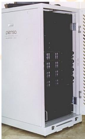
Este es un nodo de un cluster, justo al término de su instalación y configuración dentro de un “rack” que es el mueble que parece un refrigerador. Aquí vemos al rack sin su puerta frontal.
